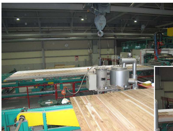
接着 接着剤を塗り、ラミナ材を縦・横交差するように貼り合せる。
