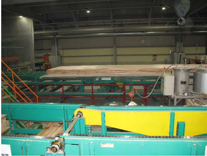
プレス、乾燥施設 貼り合わされたボードを左側のプレス、乾燥の工程へ搬送する。
