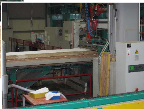
接着 接着剤を塗り、ラミナ材を縦・横交差するように貼り合せる。
