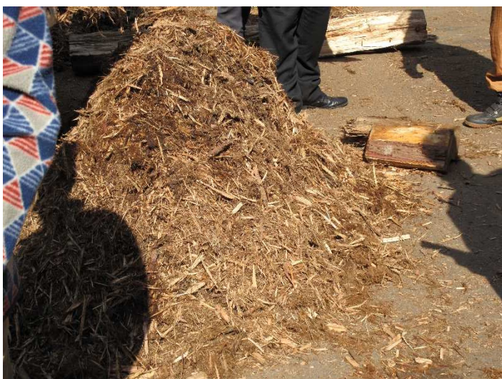
排出されたピンチップ。 バイオマス発電所への燃料(チップ)供給は、含水率を 50%以下に調整する為、その1で製造された切削チップと混ぜ合わせ出荷される。
