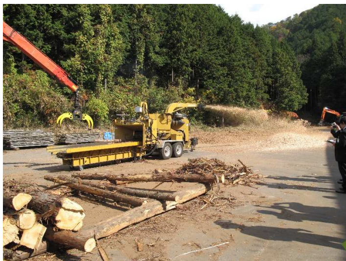
投入口より木材を投入し、切削チップ化する。
