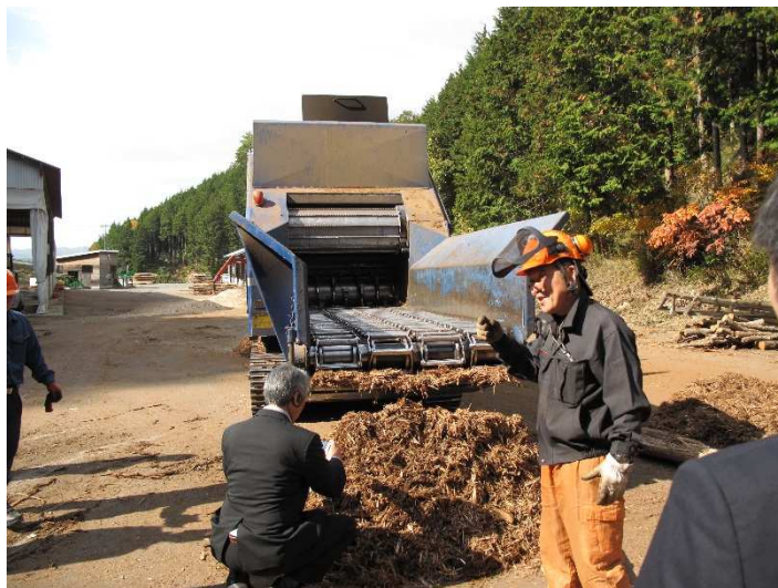
投入口より木材を投入し、ピンチップ化する。
