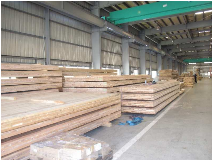
完成 出荷を待つ CLT ボード
